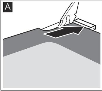
2. Riposizionare il coperchio sulla parte superiore della porta del forno e premere leggermente. Fare attenzione affinché le scanalature sui lati siano inserite correttamente.
