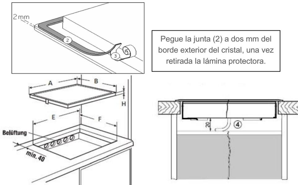
Pegue la junta (2) a dos mm del borde exterior del cristal, una vez retirada la lámina protectora.
