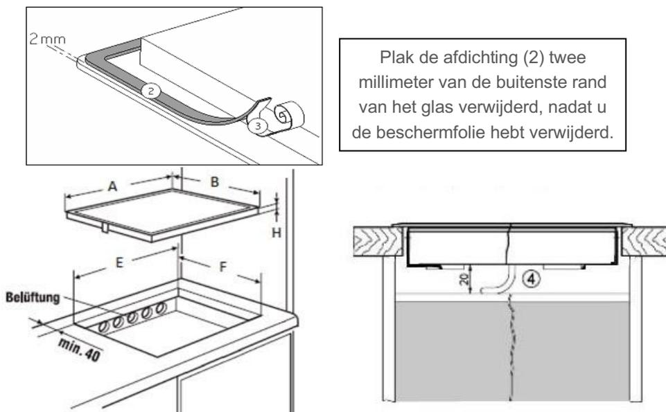
Plak de afdichting (2) twee millimeter van de buitenste rand van het glas verwijderd, nadat u de beschermfolie hebt verwijderd.
