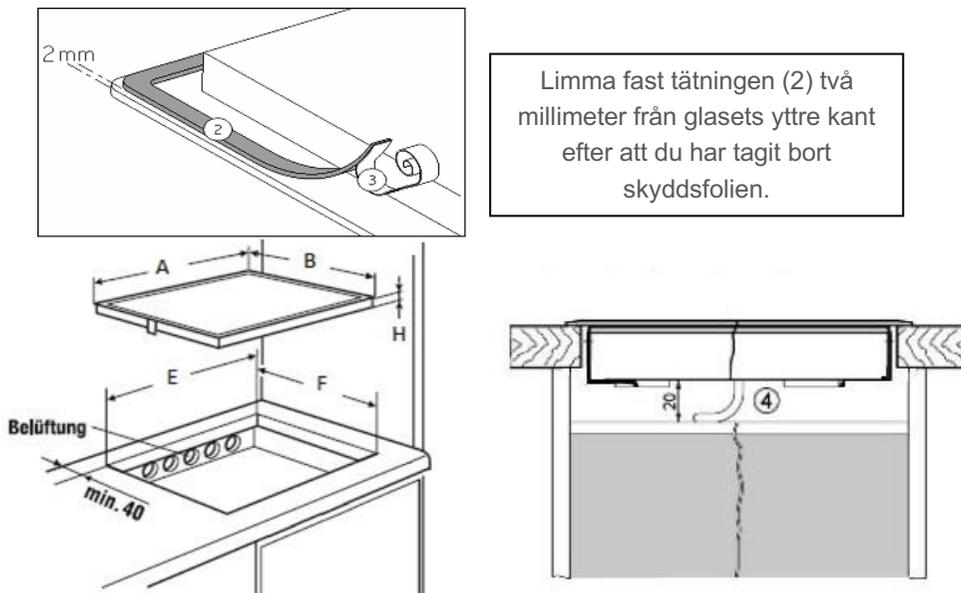
Limma fast tätningen (2) två millimeter från glasets yttre kant efter att du har tagit bort skyddsfolien.
